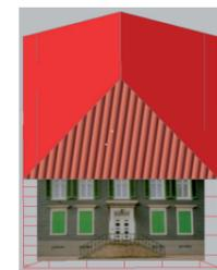
Abhelfen kann man, indem die Mapping-Ebene an der Dachebene ausgerichtet wird. Dazu ruft man den Menüpunkt Ebenenmapping auf und pickt die Dachfläche. Man erkennt, dass die Ebene nicht korrekt orientiert ist. Durch verschieben und drehen lässt sich die Ebene anpassen. Geben Sie in der Befehlszeile den Buchstaben v
