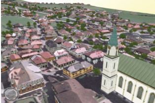
Einfachere Baukörper können weitgehend automatisiert erstellt werden. Komplexe Baukörper hingegen, wie die Kirche, werden mit AutoCAD Architecture von Hand modelliert.
